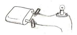
Die Funktionstüchtigkeit des Spannungsprüfers kann getestet werden, in dem man die beiden losen Drahtenden zusammenfügt. Dann ist der Stromkreis geschlossen, die Lampe muss leuchten!
